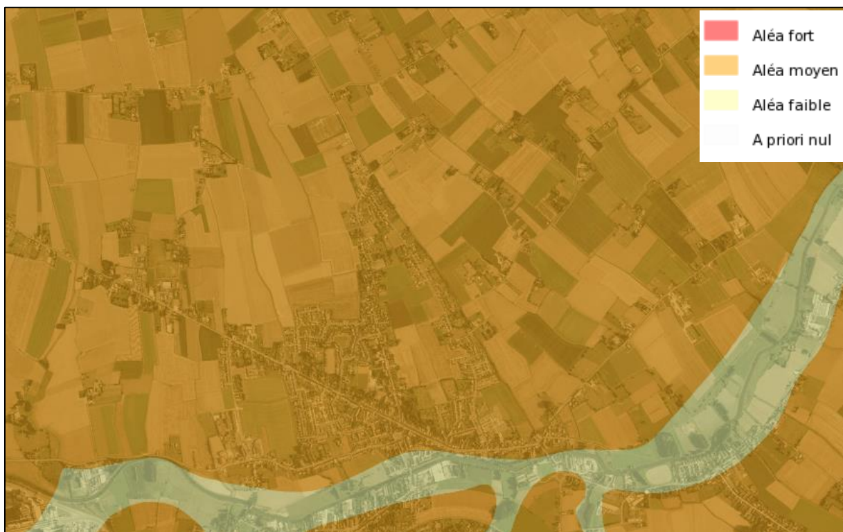
Figure 11: aléa retrait et gonflement des argiles (georisque.gouv)
