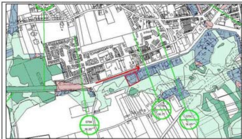
Schéma de principe de définition de la cote de crue centennale au droit de la parcelle aménageable (ici, 16,85m, la flèche rouge indiquant le sens d'écoulement du cours d'eau)
